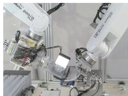
高級ローソクへのシール貼り作業をロボット技術で実現。すでに現場に導入している
