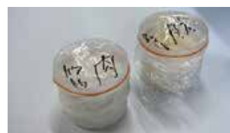
人体からの電波の反射を調べるために作成した試料。左は筋肉、右は脂肪の物性を再現
