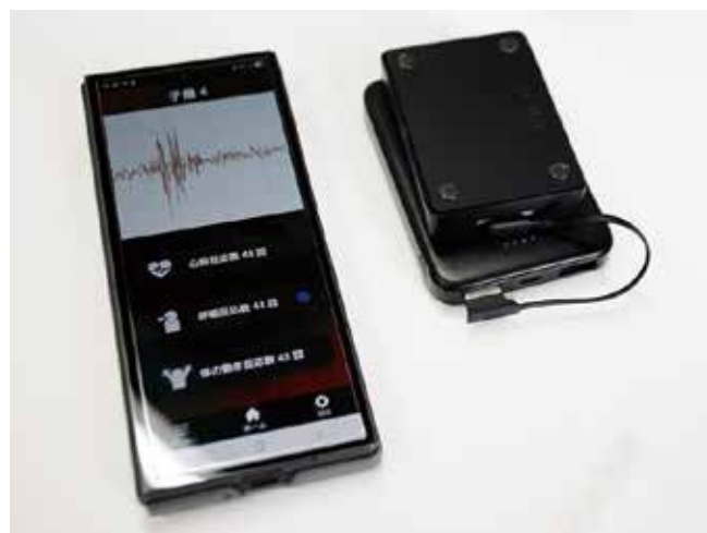
ケイ・ピー・ディが開発した人命探索用の小型レーダーセンシング機「ミマモレーダー」（右）。災害発生時に、この装置を瓦礫の上に置くと、生存者が埋もれている場合、心拍や呼吸、身体の動きを捉え、リアルタイムでそのデータをスマートフォン（左）に表示する
