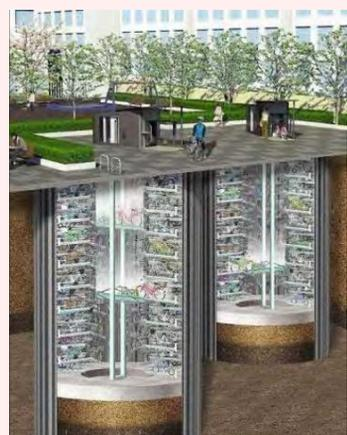
図 地下機械式自転車駐輪場イメージ
