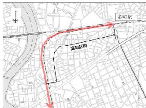
図 既存線路上に高架橋を新設して接続する方法（ケースAの例）
