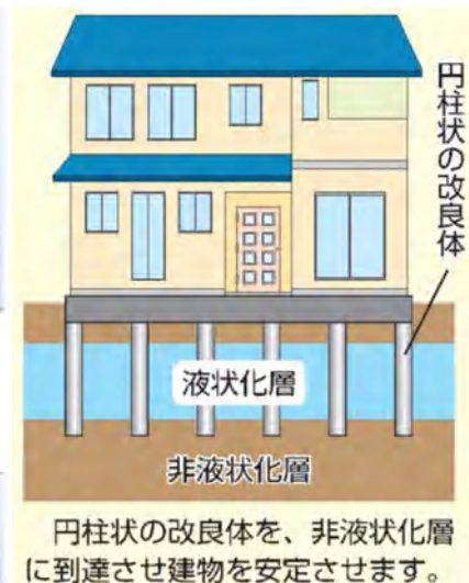
対策工事の例
